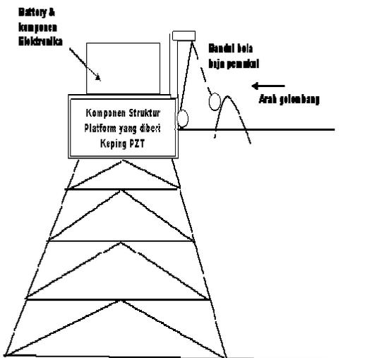
Gambar 7. Konsep pembangkit listrik tenaga gelombang laut berbasis material PZT memakai buoy pemukul platform memakai bandul bola baja
